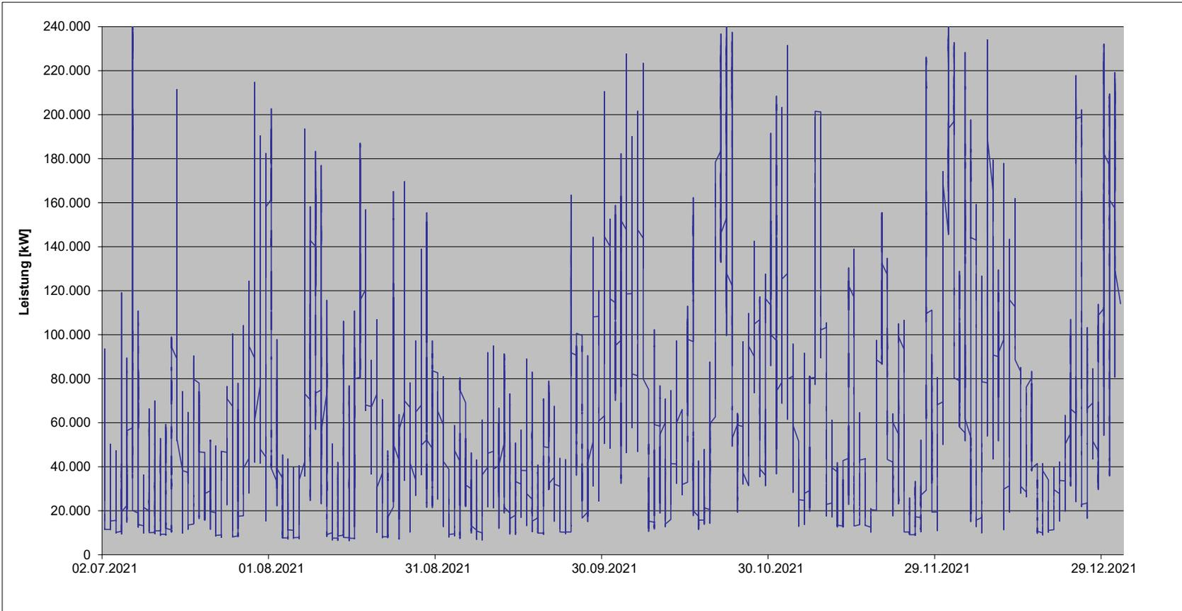
Lastverlauf der Einspeisungen in die Umspannung MS/NS der NEW Netz GmbH im Jahr 2021 (1. Halbjahr)
