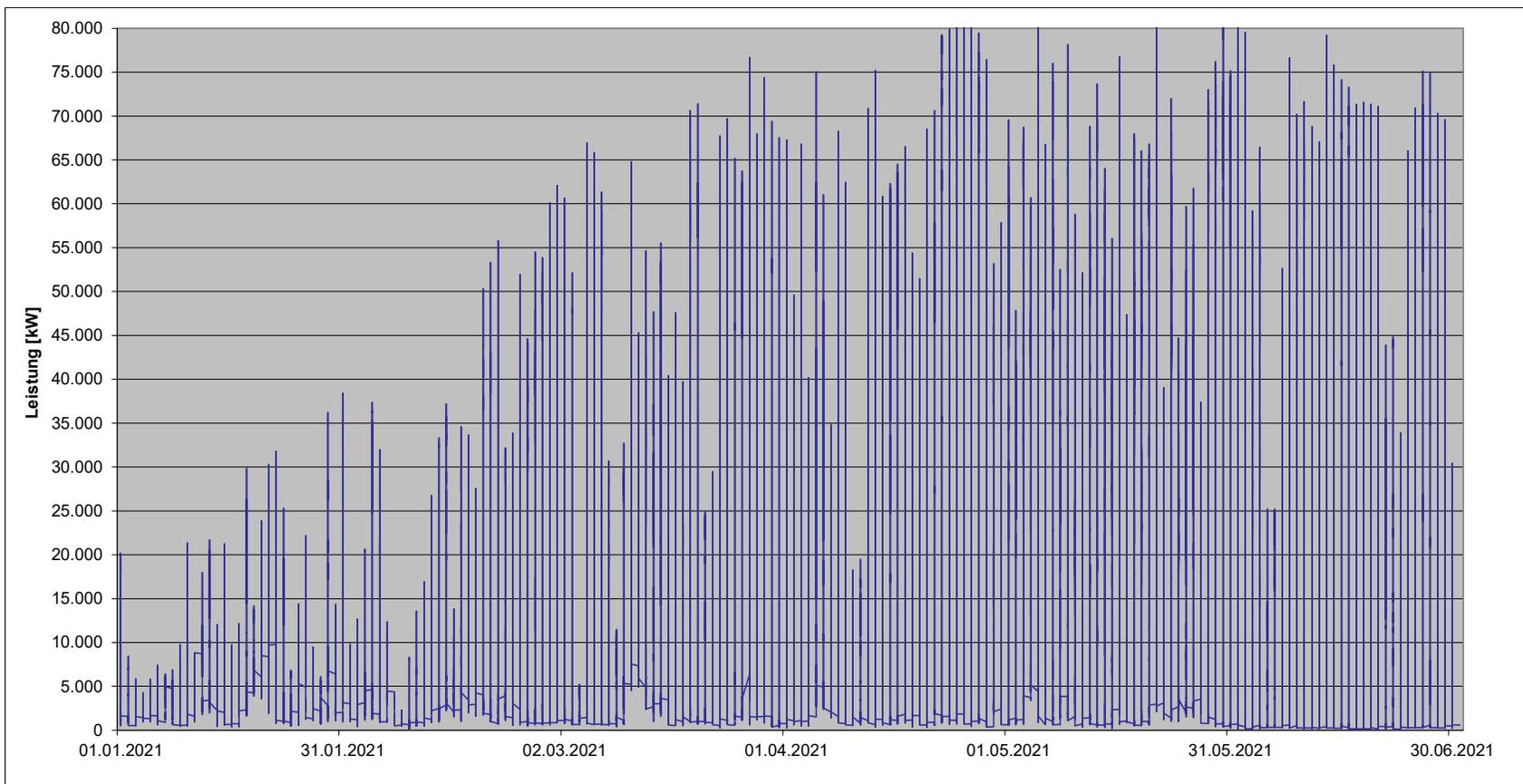
Lastverlauf der Einspeisungen in die Niederspannungsebene der NEW Netz GmbH im Jahr 2021 (2. Halbjahr)
