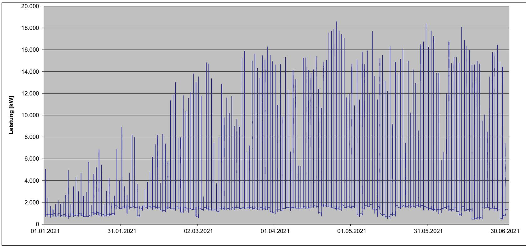
Lastverlauf der Einspeisungen in die Umspannung MS/NS der NEW Netz GmbH im Jahr 2021 (2. Halbjahr)
